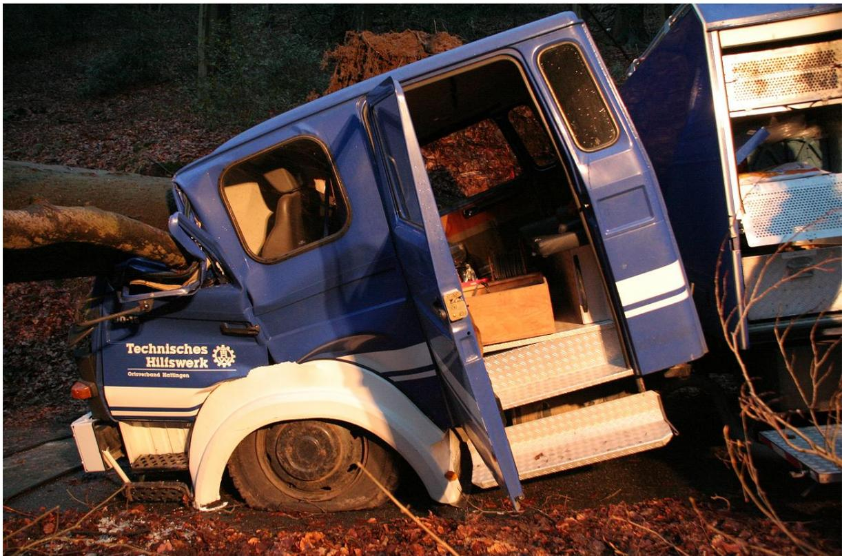
Abb. 3.a und b: MLW 3 unter dem Baum. Achten Sie auf den völlig zerstörte Fahrer-/Beifahrerbereich. (Foto: Michael Glöckner, THW Hattlingen)
